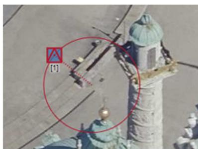
Abb. 12 Anzeige eines Messwiderspruchs anhand eines Fehlerkreises in MEASUREE
