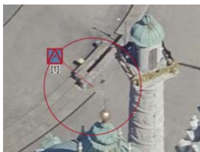
Abb. 12 Anzeige eines Messwiderspruchs anhand eines Fehlerkreises in CAPTURECAT
