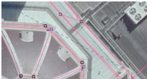
Abb. 19: Hilfslinien (blau strichliert) helfen bei der Konstruktion von Objekten in schwer einsehbaren Bildbereichen
